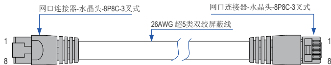
图 7 EtherCAT 网线制作要求
